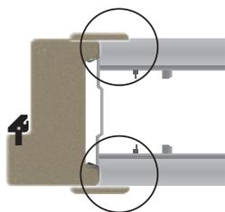
Pour une cloison d'épaisseur 72 mm : choisissez l'huisserie 72 mm avec calfeutrement. Couvre-joints nécessaires entre l'huisserie et la cloison.
