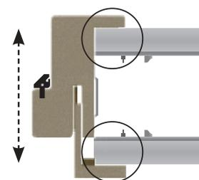
Pour toutes autres épaisseurs de cloisons : choisissez l'huisserie adaptable 50 à 202 mm. À poser en fin de chantier sur cloison montée et sol terminé.
