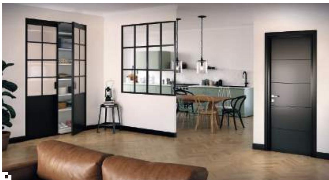
La porte de placard pivotante dispose d'un système de pivots haut et bas qui permet à la porte de s'ouvrir intégralement offrant une vision globale sur le rangement.
